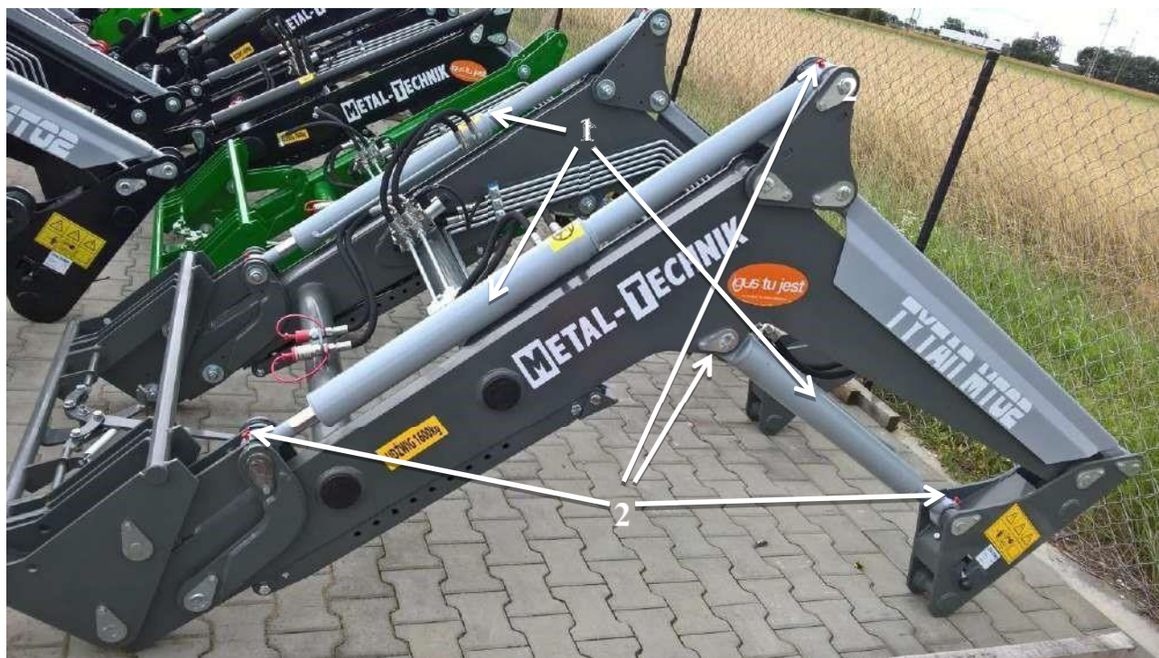
Obr. 8. Umístění mazniček: 1 - píst, 2 - maznice
