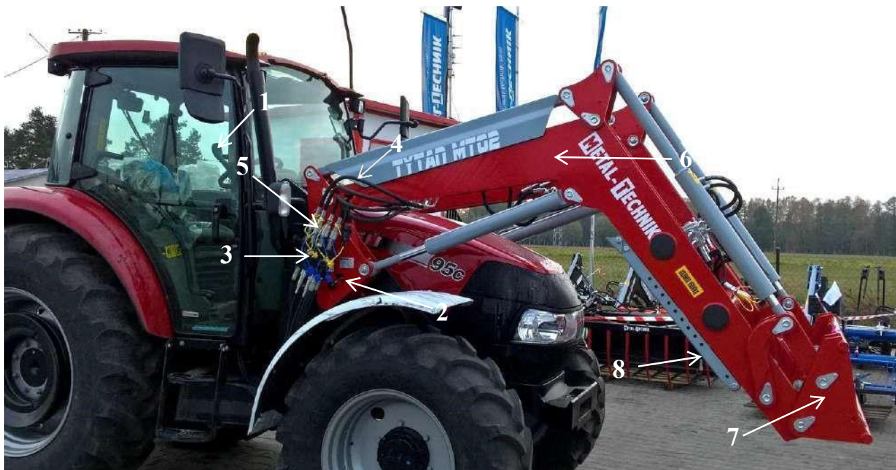
Obr. 5. Konstrukce nakladače: 1-ovládací páka, 2-zajištění, 3-hydraulický rozdělovač, 4-hadice, 5-rychlospojky, 6-výsuvné rameno, 7-rychloupínací rám, 8-parkovací podpěra
